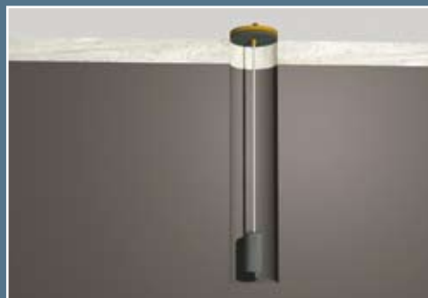
Når cykelnøglen ikke er i brug, holdes den nede i cylinderen ved hjælp af et lod.
