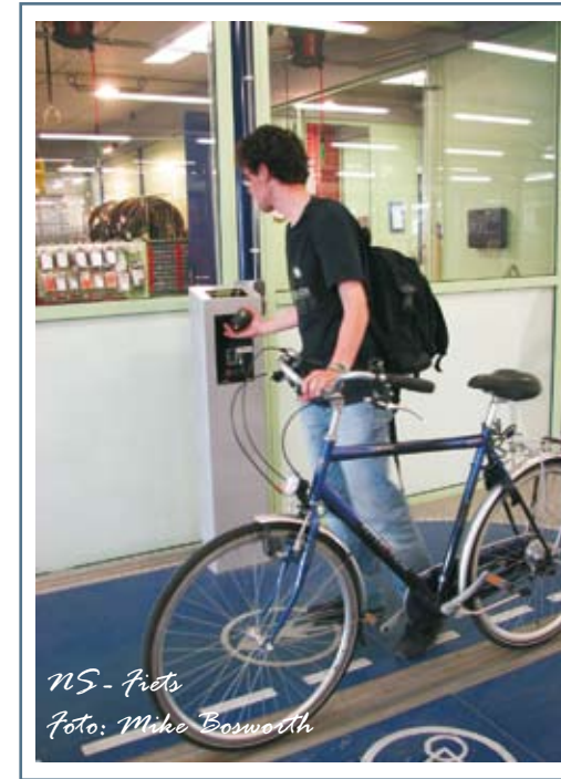
Abonnementskort aflæses af anlægget, når kortet har passeret en føler.
