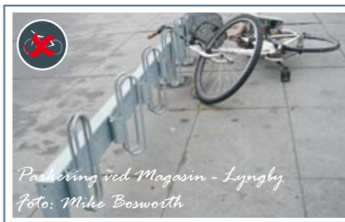
Dårligt stativ der ikke "griber" tilstrækkeligt om forhjulet. Stativet er model 51 GE fra Veksp.
