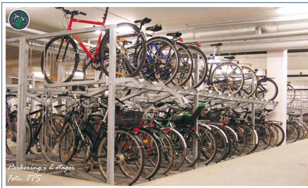
Tysk toetagers stativ fra Orion med slidsesystem, der letter parkering af cyklen på de høje niveauer.
