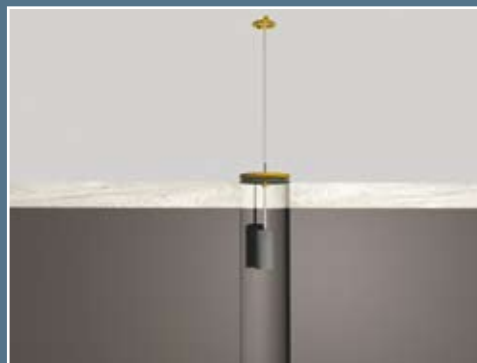
Når cykelnøglen skal anvendes, justerer loddet længden af wiren, og holder den stram.
